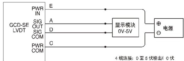
4 线连接: 0 至 5 伏输出 (0 伏远端, 5 伏位于出线端)
