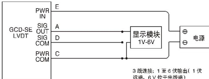
3 线连接: 1 至 6 伏输出 (1 伏远端, 6 V 位于出线端)
