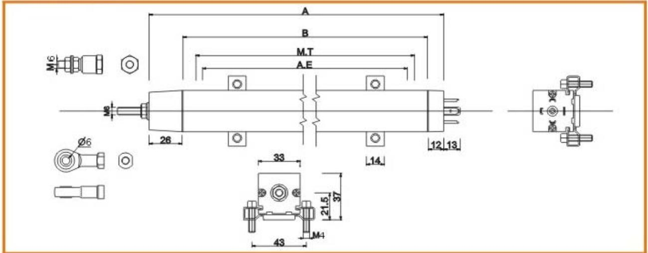
**应用范围:** KTC是一般通用型, 適合各類型設備的位置檢測。如: 注塑機、壓鑄機、橡膠機、鞋機、EVA注射機、木工機械、液壓機械等。
