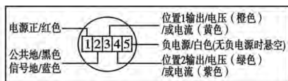
双位置输出接线端子接线图
